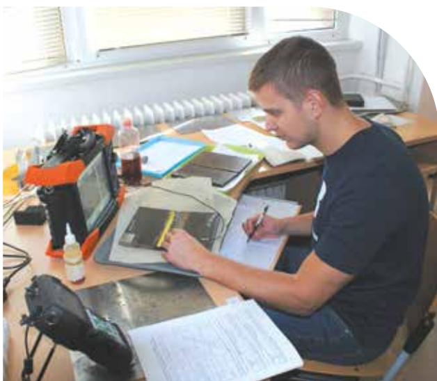
Gekko márkájú ultrahangos vizsgálóberendezés, mellyel hegesztett kötések és alapanyagok minősítése végezhető el
