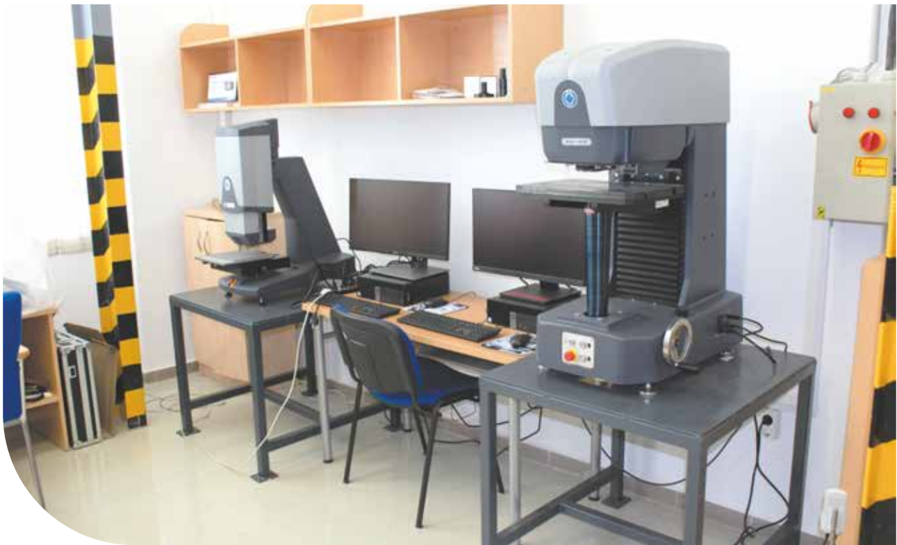
Mikro- és makro-keménységmérő gépek, melyekkel Vickers-, Knoop- és Brinell-keménységmérést lehet végezni fémeken és fémötvözeteken, de akár kerámia- és üvegfelületeken is
