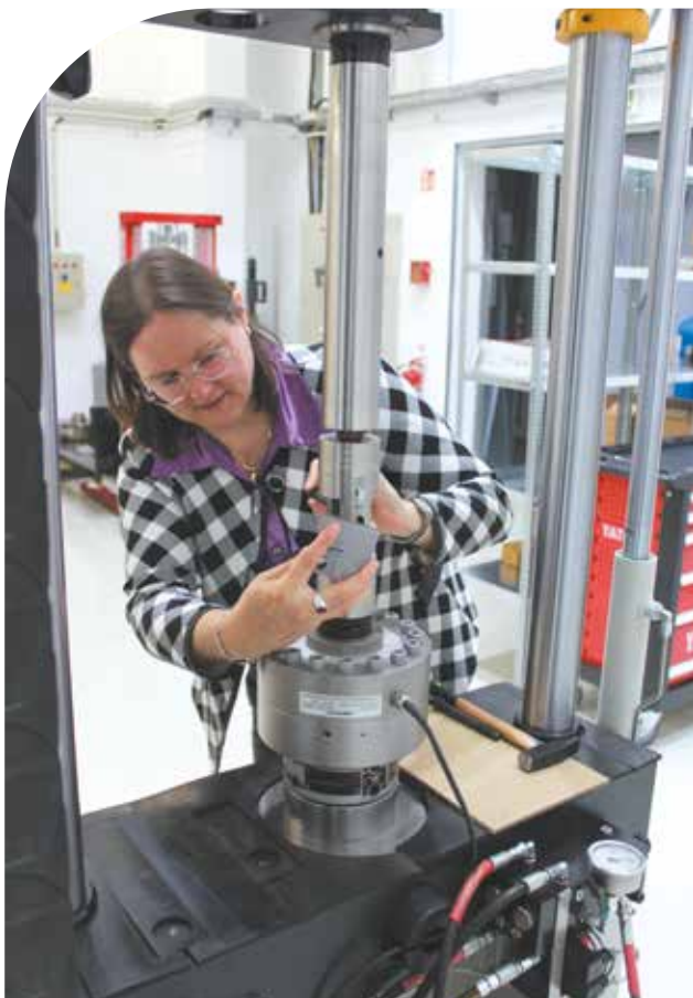
Univerzális anyagvizsgáló gép, mellyel -70\text{ }^{\circ}\text{C} és 1000\text{ }^{\circ}\text{C} között lehet szakító, fázisátviteli vizsgálatokat végezni különböző acélminőségeken
